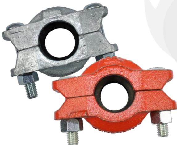
El Acoplamiento flexible Shurjoint Modelo 7707 para trabajo pesado, está diseñado para uso en una variedad de aplicaciones generales de tuberías de servicio de moderada y alta presión. La presión de trabajo es usualmente determinada por el espesor de la pared de la tubería y el rango de la tubería usada.
