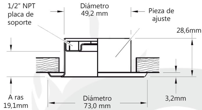
**Figura 2 - Estilo 40: 3/4" NPT con ajuste de 19,1mm.**
