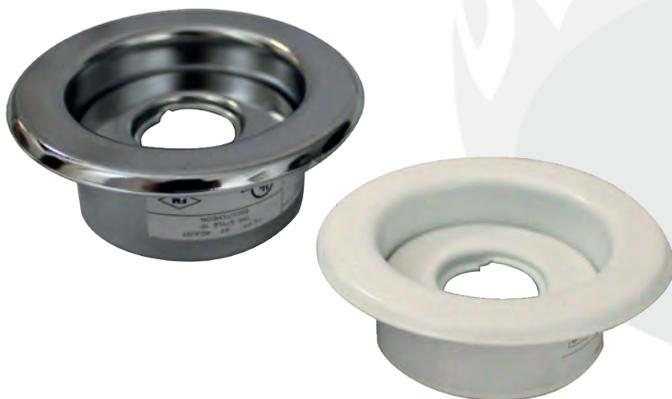
Los embellecedores empotrados están pensados para su instalación en falsos techos con ciertos sprinklers de pared colgantes o montantes. El ajuste proporcionado por estos embellecedores reduce la precisión con la que se deben cortar las tuberías fijas a los sprinklers, al tiempo que proporcionan una instalación decorativa de sprinklers empotrados.
