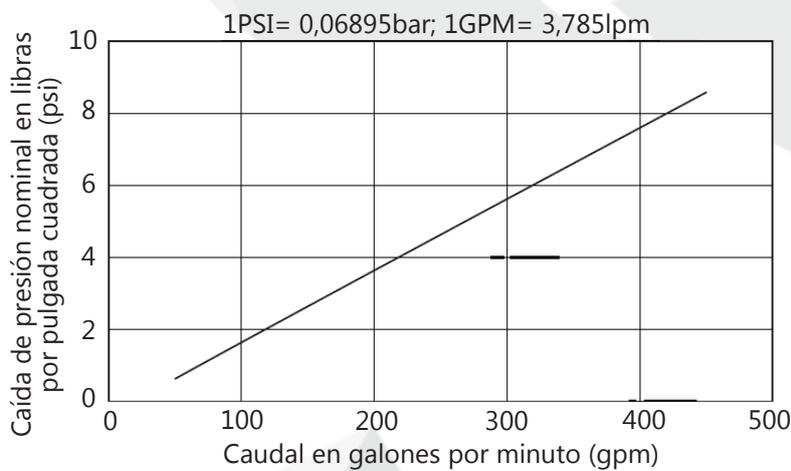
**Gráfico C: Válvula reductora de presión PRV-1A de 4" (DN100) - Caída mínima de presión.**
