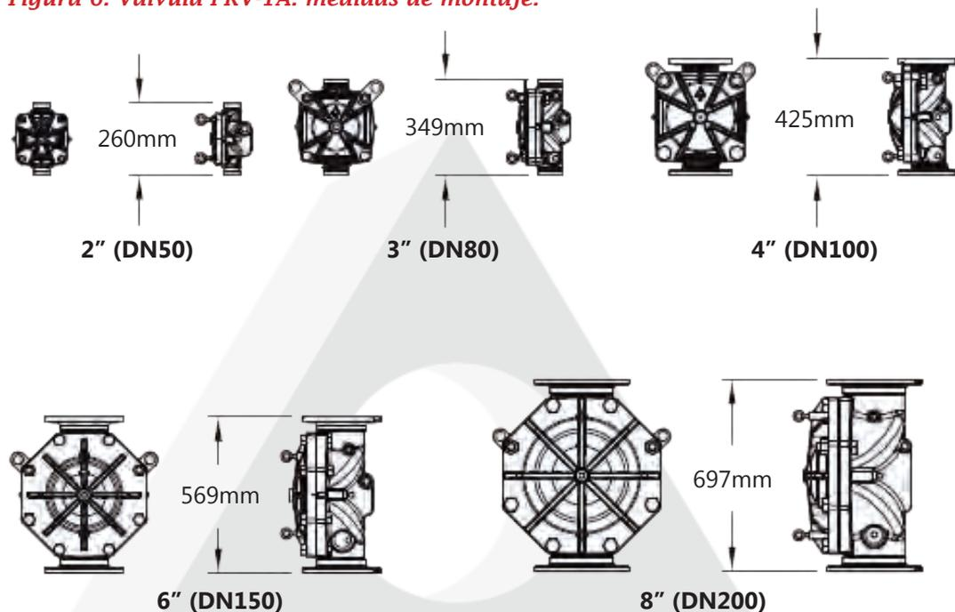
Las medidas indicadas se aplican a todas las configuraciones de conexión final posibles en función del tamaño de la válvula.
