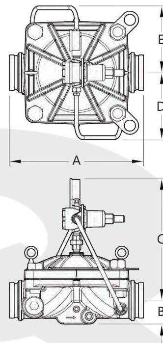
Figura 9: Válvula PRV-1A: Conexiones finales Brida x Brida - Medidas nominales de la instalación.
