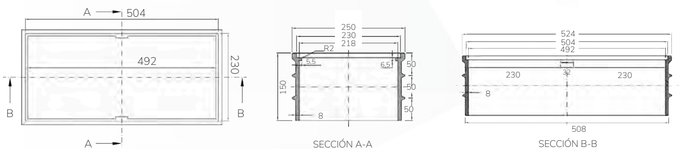
FIGURA 6: Plano Arqueta para GEYSER 2 BOCAS
